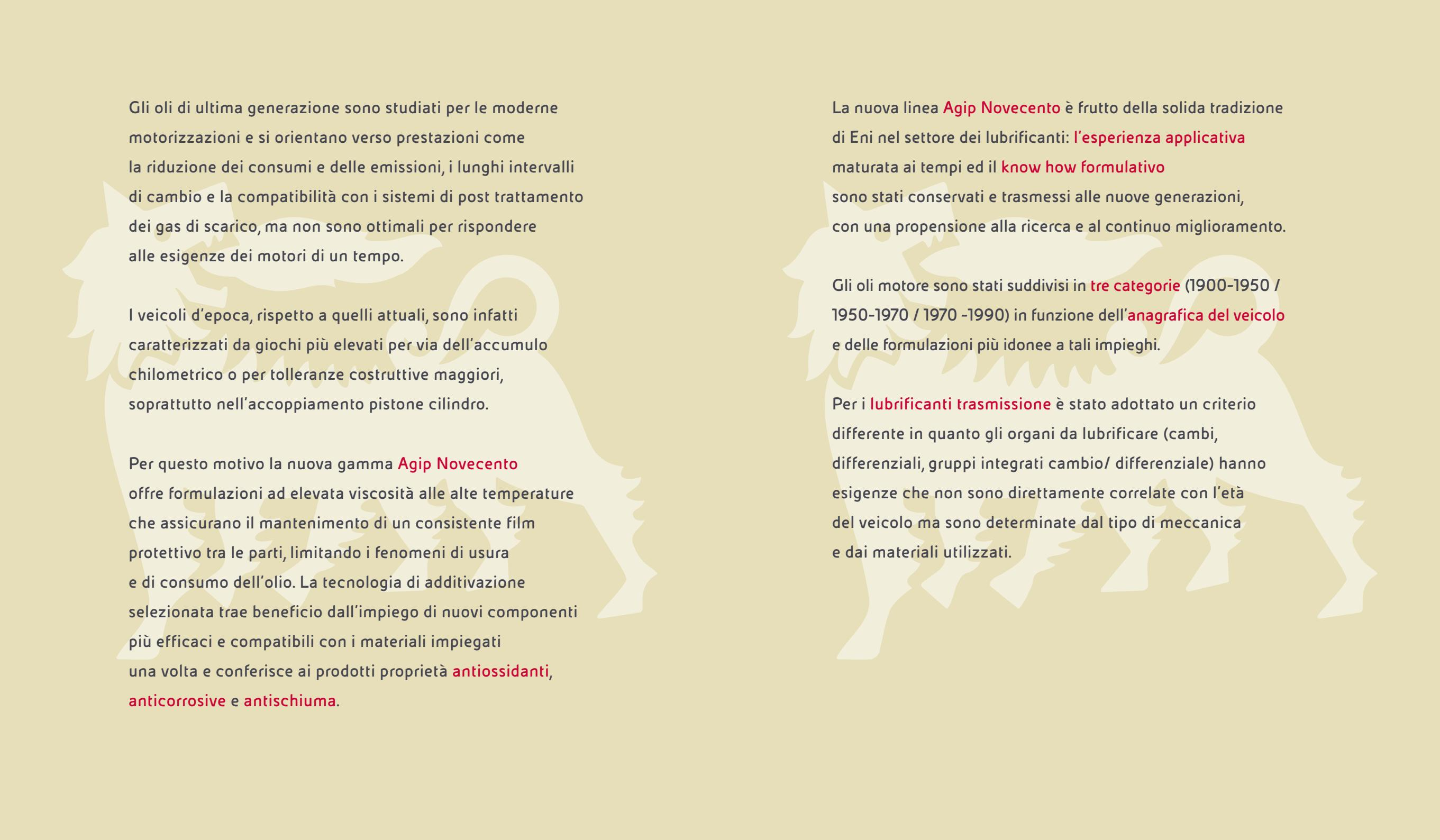
Gli oli di ultima generazione sono studiati per le moderne motorizzazioni e si orientano verso prestazioni come la riduzione dei consumi e delle emissioni, i lunghi intervalli di cambio e la compatibilità con i sistemi di post trattamento dei gas di scarico, ma non sono ottimali per rispondere alle esigenze dei motori di un tempo.
